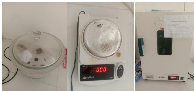
Gambar 6. Peralatan untuk menguji ikan asap (Cawan petri, timbangan dan oven)
