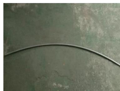
Pengujian pengerolan besi square hollow dan pipa seperti membentuk radius seperti pada gambar (7) yaitu gambar (a) dan (b).
