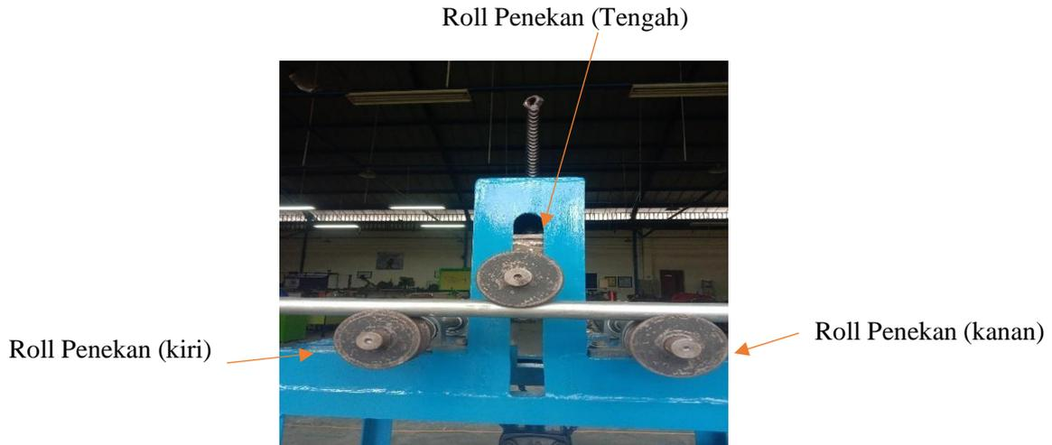
Gambar 5. Pipa melewati roll penekan sampai di atas roll pendukung 3
