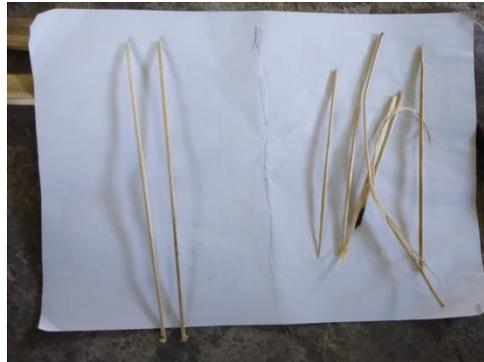
Gambar 9. Hasil penyerutan bambu (panjang 20 cm, lebar 6 mm)
