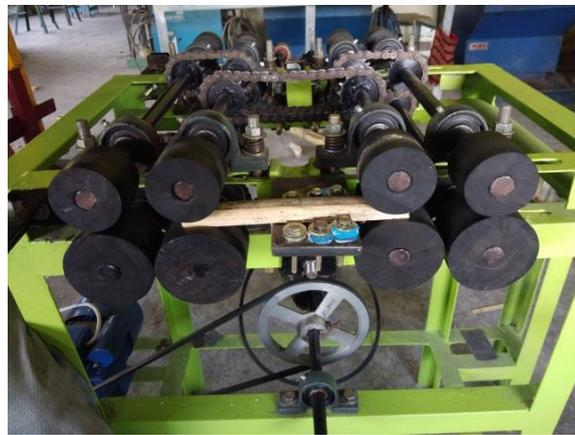
Gambar 6. Pengiratan bambu ketebalan 15 mm
