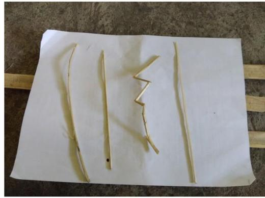
Gambar 8. Hasil penyerutan bambu (panjang 20, cm lebar 3 mm)
