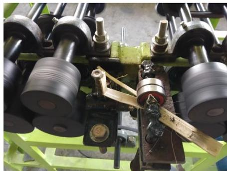
Gambar 10. Hasil penyerutan bambu (panjang 20 cm lebar 9 mm)
