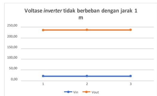
Berdasarkan grafik Gambar 6 voltase pada input inverter menghasilkan 12.12V sedangkan voltase output inverter 218V dengan kecepatan blower dipengaturan 250V.
