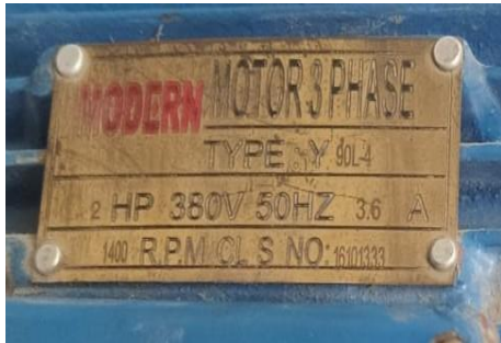
Gambar 2. Spesifikasi Motor Induksi 3 Fasa
