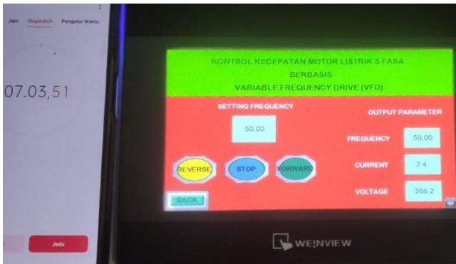
Gambar 12. Performa Motor Induksi terhadap Beban Konstan menggunakan VFD
