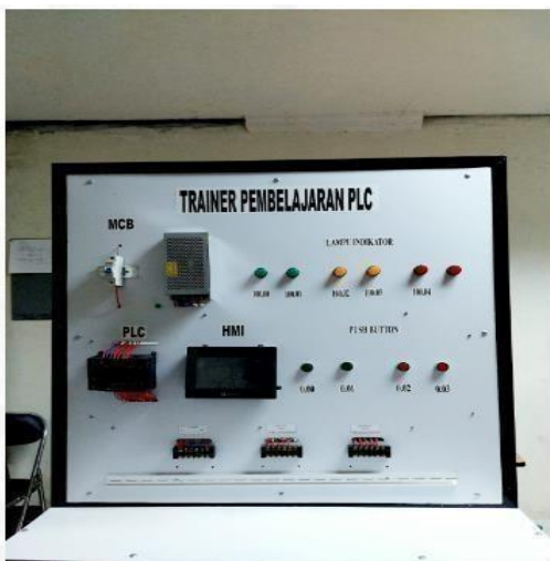
Gambar 3.3 Hasil pembuatan trainer plc
