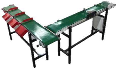
Gambar 3. Mesin Sortir Ikan Berdasarkan Berat
