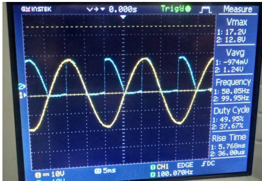
Gbr.15 hasil pengujian penyearah gelombang penuh terkendali
