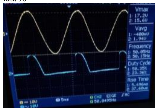
Gbr.14 hasil pengujian penyearah setengah gelombang terkendali
