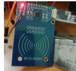
Gambar. 5 Metode Pengambilan Data Jarak Deteksi RFID RC522
