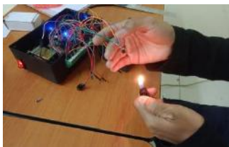
Gambar. 6 Hasil Pengujian Pada Sensor LM35
